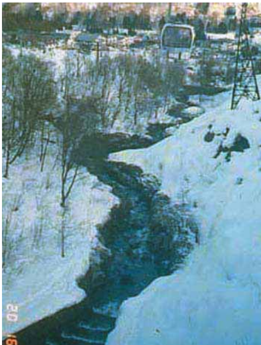
図 3 土水路を流下した雪泥流の super elevation の痕跡 (長野県小谷村柵池高原スキー場・から沢, 1990年2月11日発生).
