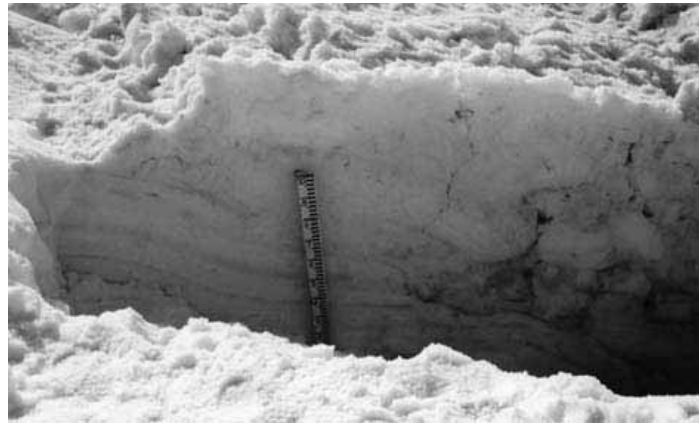
図 5 積雪に乗り上げて停止した雪泥流デブリの断面に見られる雪塊の混入状況 (新潟県南魚沼市・鎌倉沢川, 1997年2月26日発生).
