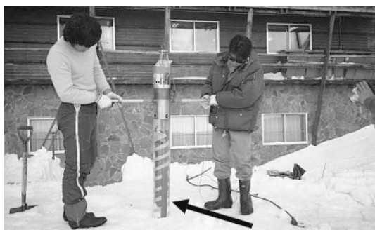
図3 透明パイプの外管内側に番線をガムテープ（矢印）で張り付け、実験再開。
