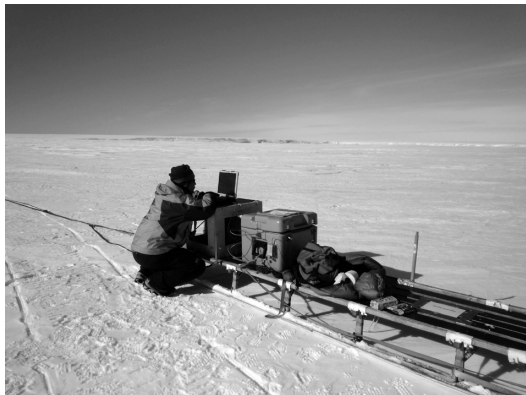
図 4 レーダ観測の様子。ナンセン橇の上に設置されたレーダ受信機とそれを動作させるための小型発電機。左手に見えるのは送信機橇牽引用ロープとアンテナ。二つの橇とアンテナがスノーモービルの後方に一列に並び、100 m 長程度の隊列となる。スノーモービルのドライバーとナンセン橇に乗る観測者の 2 人で観測して行く。
