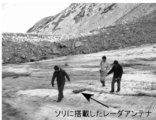
図 3 探査の様子 (Line-NS2)。雪溪の表面は融雪水で飽和した積雪で覆われている。背後に見える岩屑地形はターミナルモレーン。
