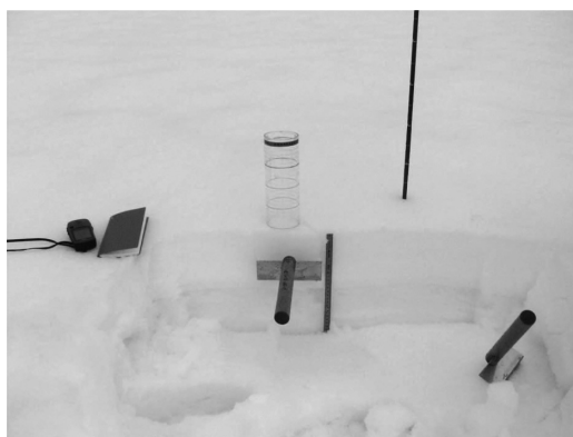
図 2 雪試料の採取方法. 用具は円筒サンプラー, 雪べら, 折尺, 測深棒, GPS および筆記用具.
