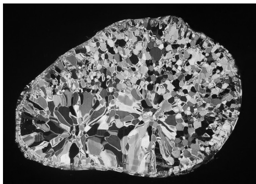
図 3 しぶき氷の水平断面の薄片偏光写真。サンプルの横幅は 8 cm である。
