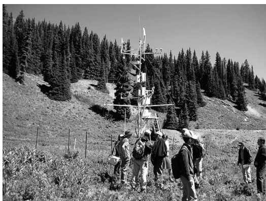
図 3 Swamp Angel Study Plot の観測サイトにある自動気象観測装置 (AWS).
